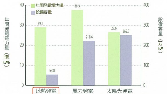
地熱発電、風力発電、太陽光発電の 2005年度年間発電電力量と設備容量の比較
